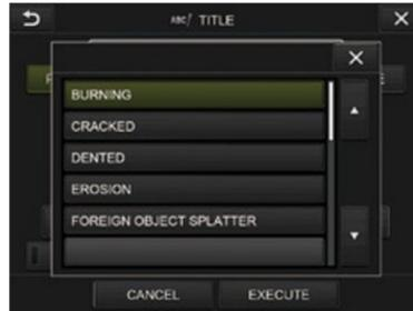
**El software de asistencia de inspección InHelp** agiliza el registro y la gestión de los datos mejorando la eficiencia, simplificando las inspecciones y organizando las imágenes grabadas. Las carpetas de datos opcionales ofrecen una estructura de inspección estándar.
