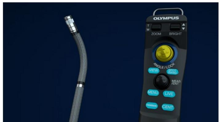
Al llegar al objetivo de inspección, la iluminación LED del videoscopio IPLEX GAir proporciona un nivel constante de brillo independientemente de la longitud. El nivel de brillo también es regulable, por lo que es posible disminuirlo cuando la sonda se desplaza por las tuberías de diámetro pequeño e incrementarlo cuando se trabaja en áreas grandes.
