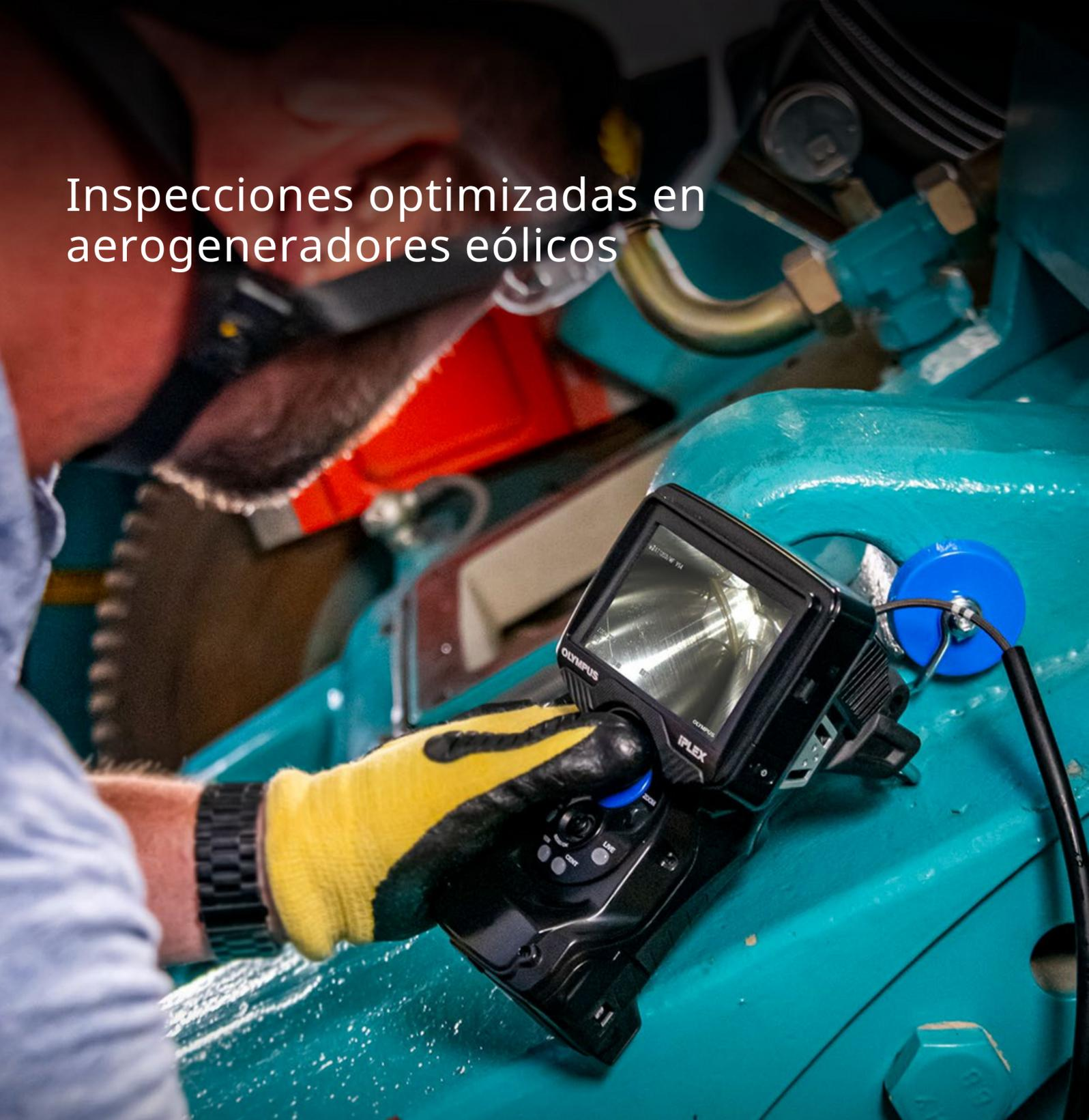
Si está inspeccionando los reducidos intersticios de un chasis principal de aerogenerador, su trabajo podría ser mucho más fácil gracias a la versión eólica del videoscopio IPLEX G Lite que combina portabilidad y potentes funciones de procesamiento de imágenes en una pequeña estructura. Esta versión del videoscopio IPLEX G Lite presenta características diseñadas especialmente para la inspección de aerogeneradores, como los siguientes:
