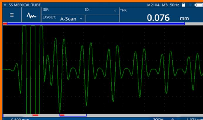
Mediciones de espesor precisas en materiales finos para optimizar el control de calidad.
