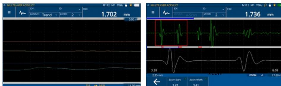
Todos los modelos 72DL PLUS comprenden cinco diseños de medición; por consiguiente, los cambios en el espesor de un material bajo ensayo pueden rastreadse y visualizarse con precisión.
