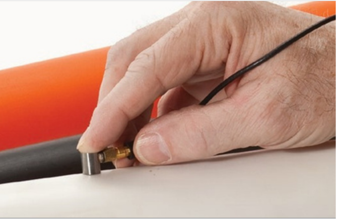
Medición de espesores en varios materiales como plástico, metal, caucho, vidrio, cerámica y compuestos.
