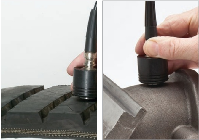
Medición de la profundidad hasta las bandas de tela con cordones de acero en bandas transportadoras o neumáticos de goma.
