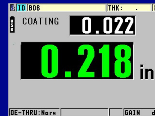
Medición THRU-COAT que muestra el espesor del revestimiento y del acero (A-scan no activo)
