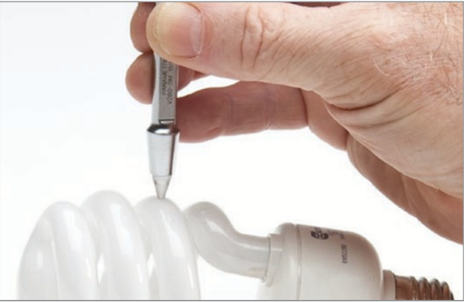
Medición de capas delgadas de vidrio con la sonda Sonopen® V260-SM.
