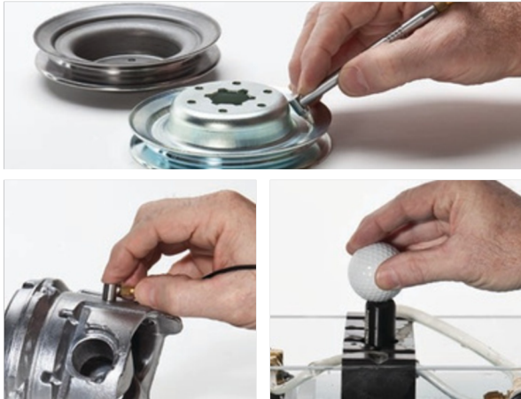
Las mediciones de espesor por ultrasonido son precisas, fiables y reproducibles. Es posible adquirir lecturas instantáneas desde un solo lado del material sin cortar o destruir las piezas.
