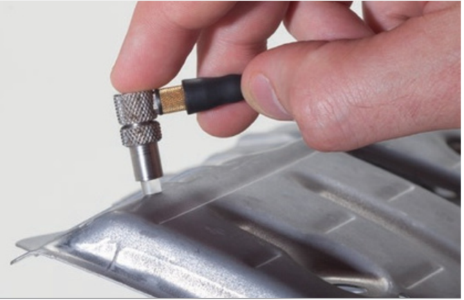
Medición de metales delgados formados por flexión o por modelado.
