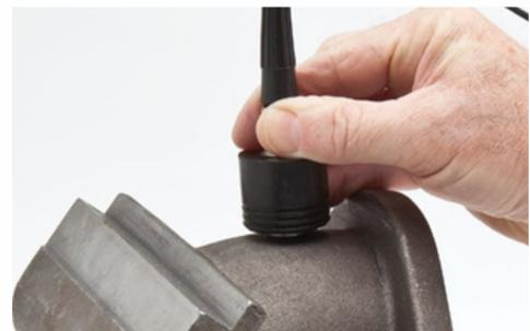
La opción de *software* Alta penetración posibilita la medición de varias piezas de fundición metálica y materiales de atenuación acústica.
