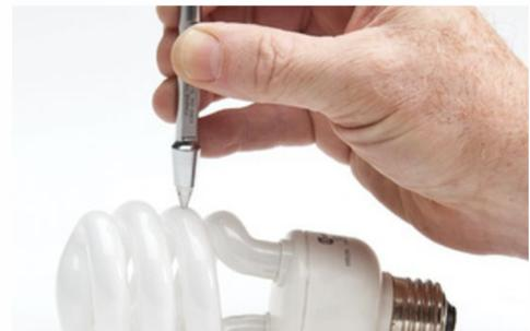
La opción de *software* Alta resolución permite medir el espesor con una resolución de hasta 0,001 mm.
