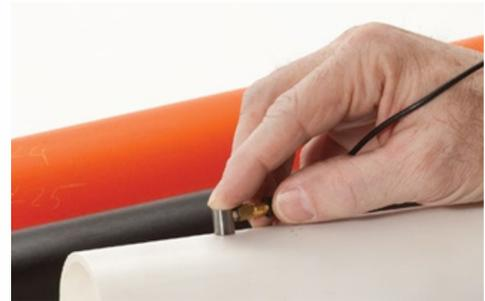
Medición del espesor de muchos materiales, como el plástico, metal, caucho, vidrio, cerámica y materiales compuestos (*composites*).
